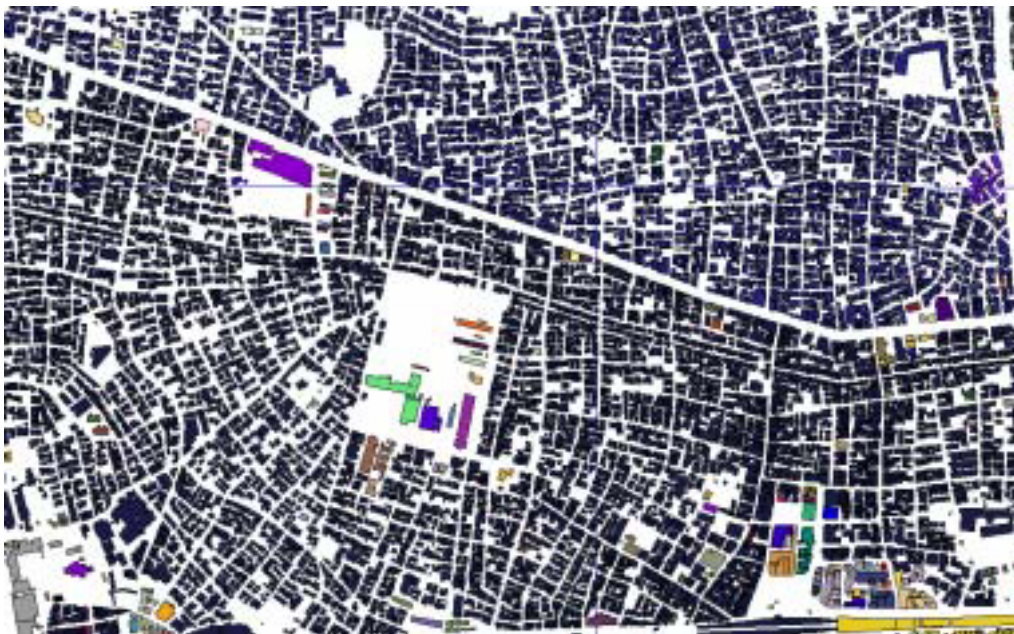
図 3-7 神戸市長田区新長田駅北側区域：阪神・淡路大震災での最大の延焼被害地区．図中赤塗り範囲は，延焼被害エリア．なお，図は平成 15 年現在のものである．同色の建物は，同じクラスターを表す．
