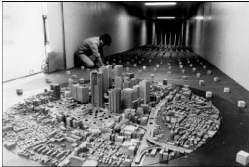
図 - 2 市街地風を模した風洞実験（第2世代：1980年代以降）
