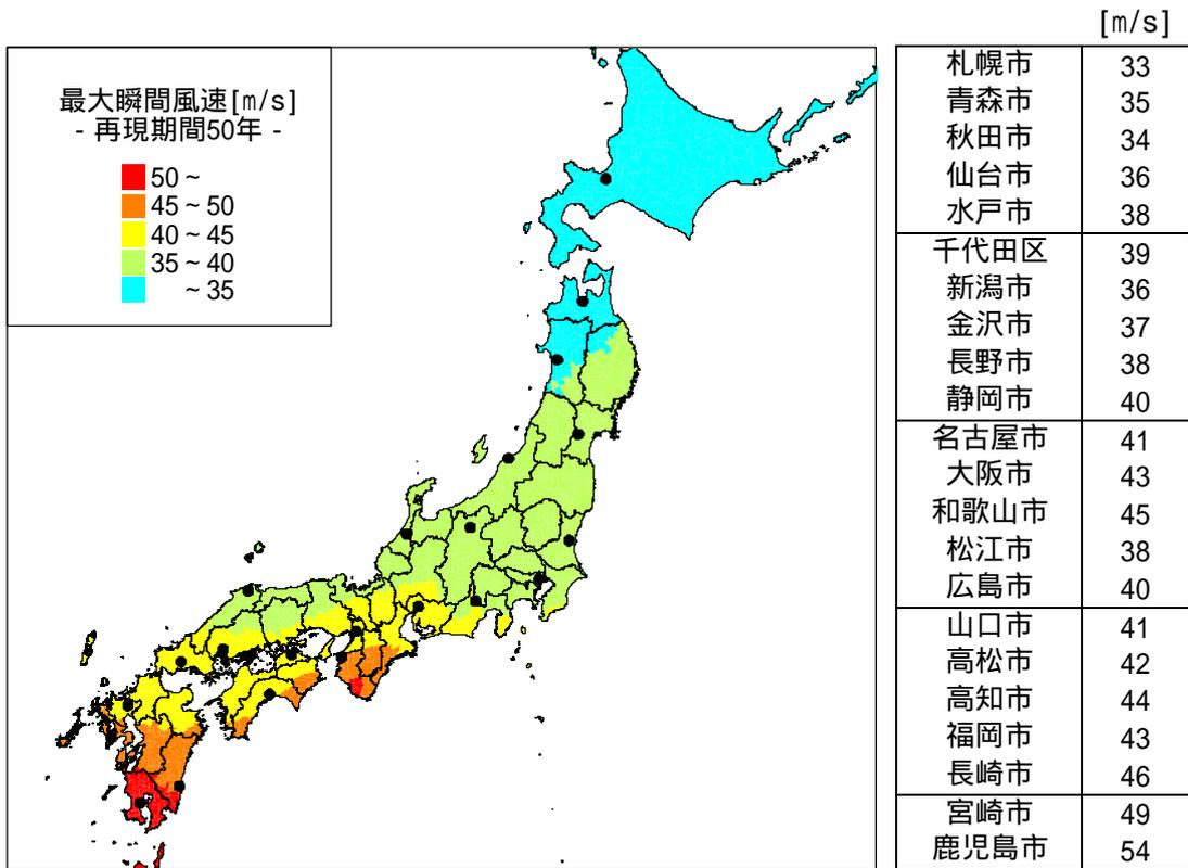
図 4.4.1 再現期間 50 年における最大瞬間風速分布と主な都市の最大瞬間風速
