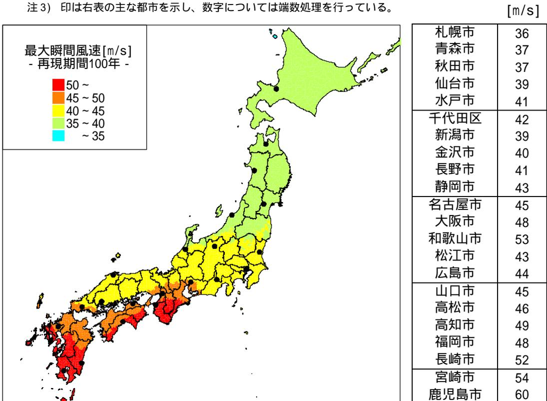
図 4.4.2 再現期間 100 年における最大瞬間風速分布と主な都市の最大瞬間風速
