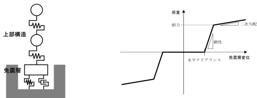
図 1 免震住宅(左図)とストッパー(右図)のモデル化のイメージ
